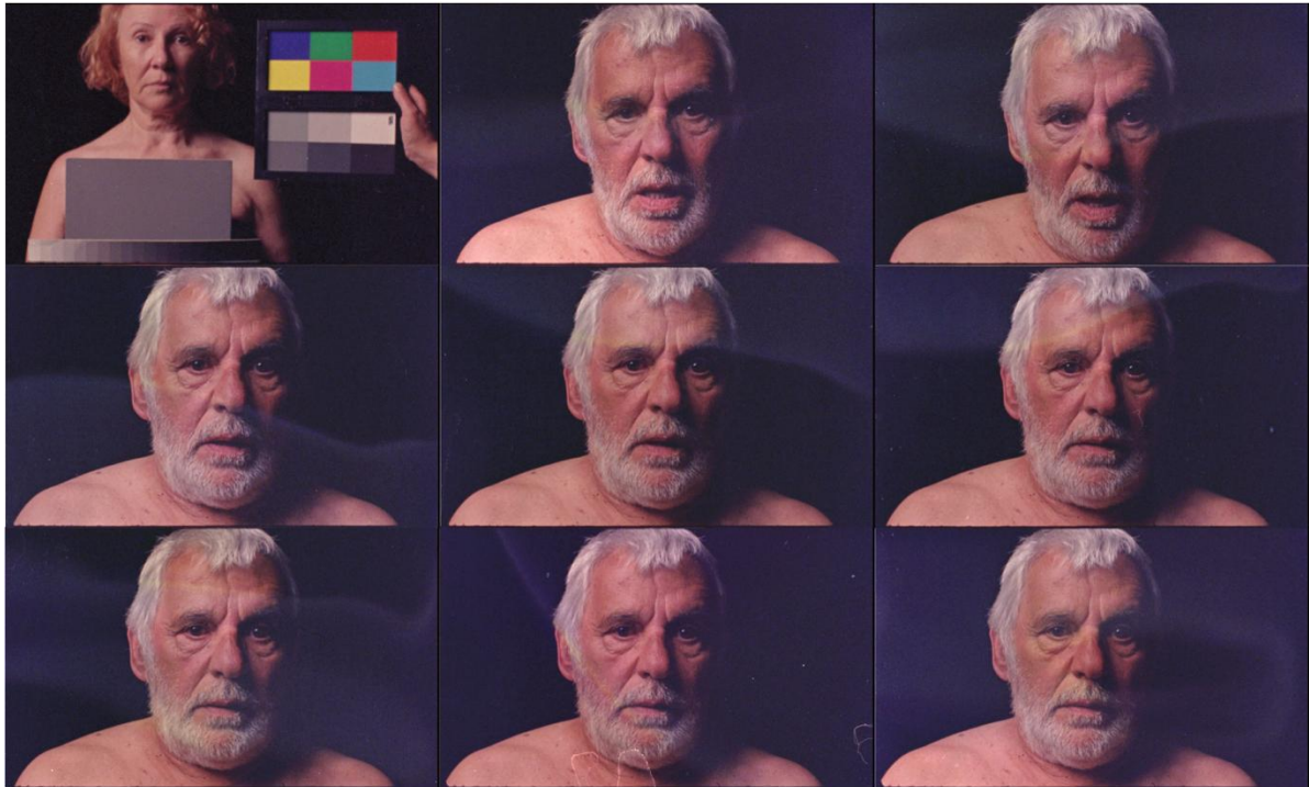
Figura 7. Plano com variação de densidade e cor ao longo de vários fotogramas, resultante de irregularidade do banho de revelação.
